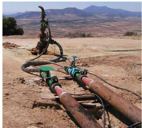
figura 28 - Pozo activo de explotación de sal.
